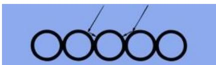
**La surface cannelée du capteur permet de récupérer une partie des rayons réfléchis.** La surface d'absorption et d'échange est ainsi multipliée par cette géométrie unique sur le marché.
