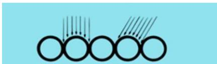
**Le rayonnement direct est absorbé par les tubes** grâce à sa géométrie arrondie et sa surface mate ne générant pas d'ombre portée et peu de reflets. La finesse de la peau des tubes permet à l'eau de récupérer rapidement cette énergie.
