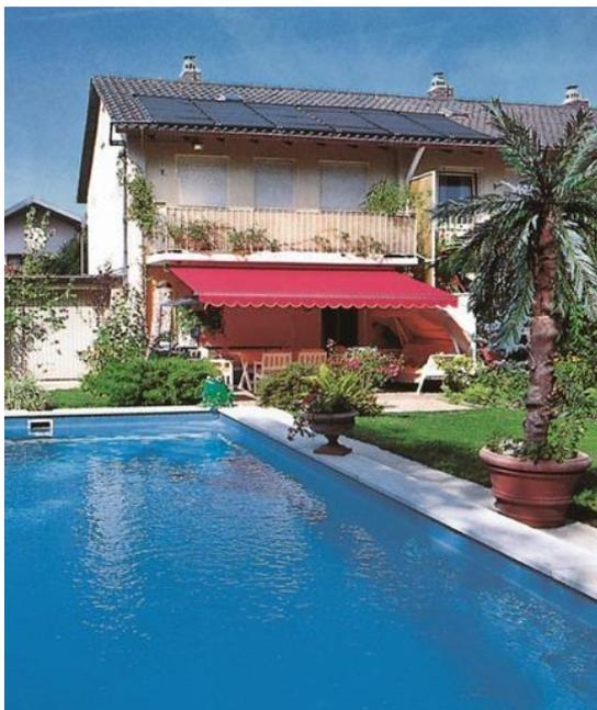
Le chauffage solaire ETM est simple et efficace. Il se branche après le filtre de la piscine, et profite donc de la pompe de filtration pour faire circuler l'eau à travers ses panneaux. Selon les conditions météorologiques, 1 m<sup>2</sup> de panneau ETM peut apporter jusqu'à 1 kW de chauffage à votre piscine. Une installation moyenne de 15 m<sup>2</sup> apporte donc jusqu'à 15 kW de chauffage ! A l'année, une telle puissance peut représenter jusqu'à 30.000 MAD de facture électrique.
